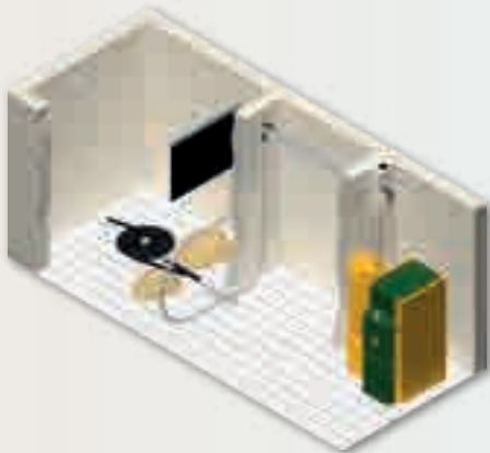
KWB Pelletrührwerk Plus mit Saugförderung
