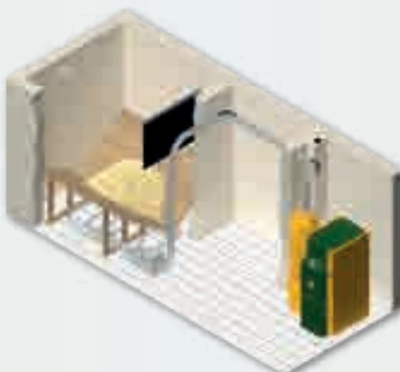
KWB Entnahmesonden mit Saugförderung
