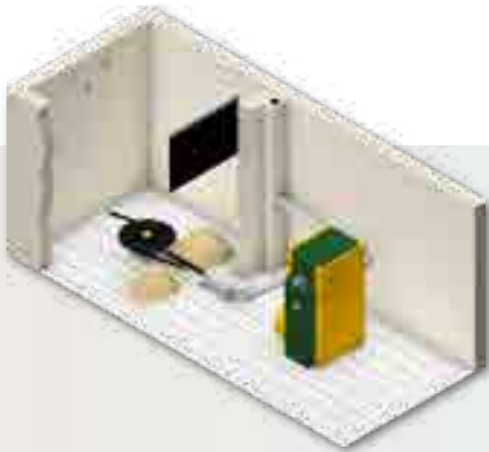
KWB Pelletrührwerk Plus mit Knickschnecke
